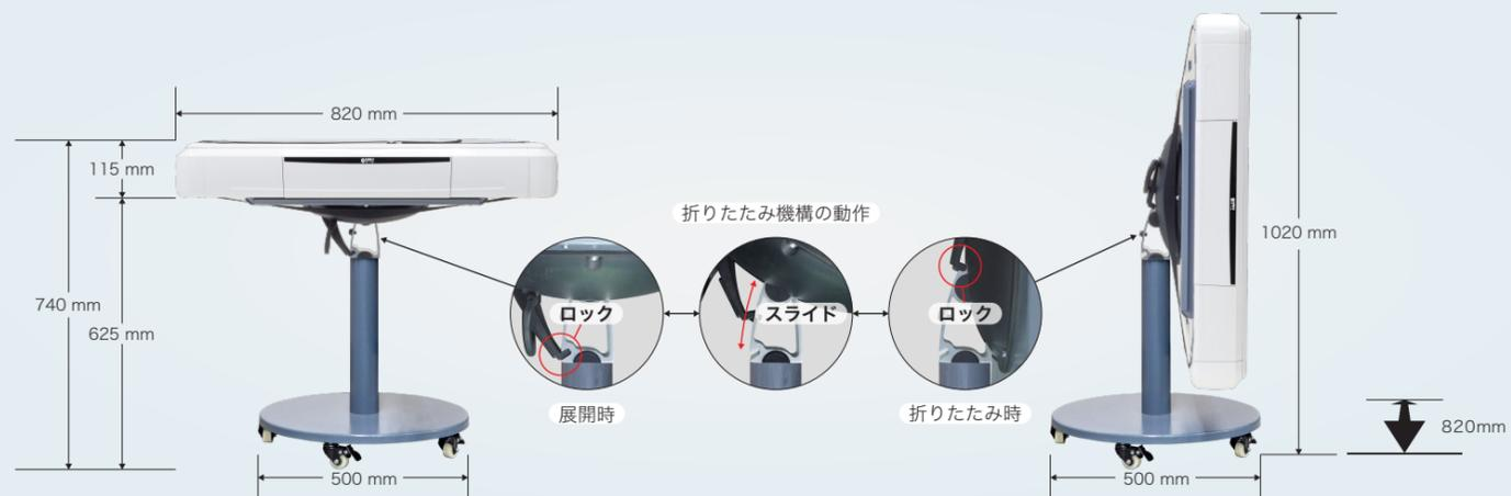
Sシリーズは、麻雀卓史上初の機能として2組の牌を麻雀卓本体のなかに収納した状態で折りたたむことが可能な機能を搭載しており、片付けや再開にかかる時間を大幅に短縮できます。折りたたみ・移動式脚タイプの折りたたみ機構は、とてもシンプルでスタイリッシュです。折りたたみや展開はレバー操作だけのワンアクションでスムーズに行なえます。折りたたみや展開時は自動でロックがかかる機構を採用していますのでネジロック式と比較してロックを忘れてしまう心配がないので安全です。折りたたみ時の奥行きは、脚のサイズ内に収まります。キャスターは、円形ベースの外周に5ヶ所設置していますので耐荷重・安定性に優れており移動もスムーズに行なえます。キャスターは5ヶ所ともロックが可能ですので、プレイ中や収納時も安心です。
